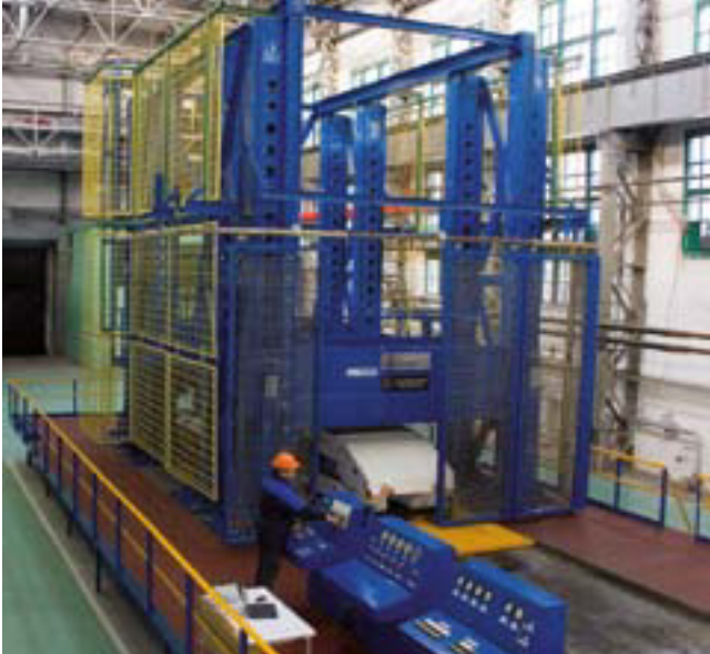
В распоряжении ООО «ПК «Юргинский машзавод» имеется испытательный стенд Gluckauf единственный в России, предназначенный для проведения прочностных и циклических испытаний секций механизированных крепей.
