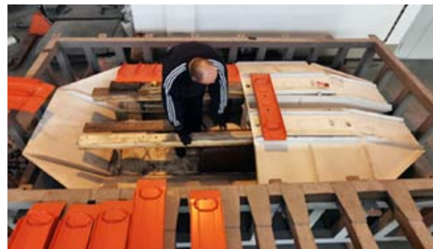
Аспиранты Института угля собирают лабораторную установку для определения радиуса чувствительности спектрально-акустического метода прогноза выбросоопасности
