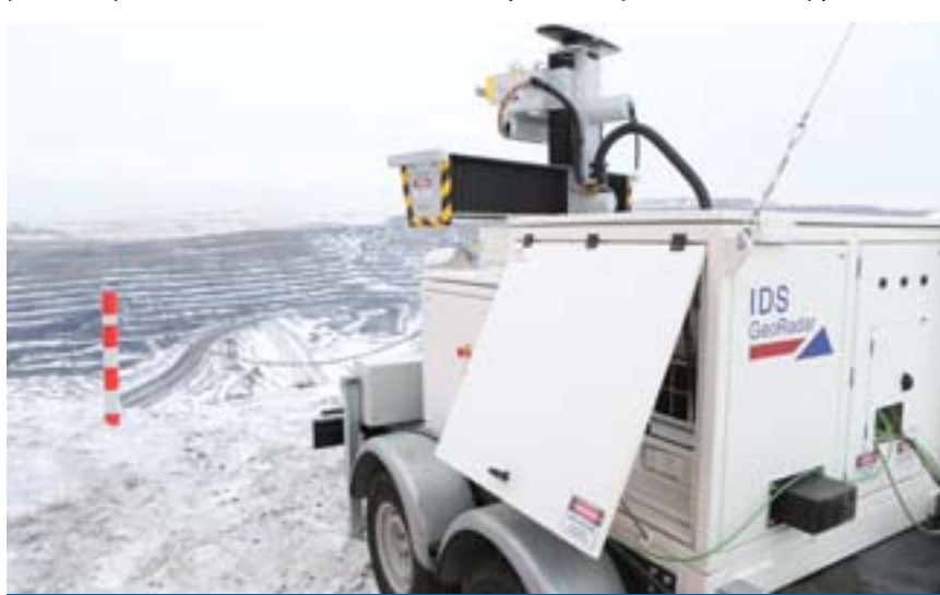
Успешно прошёл испытание и взят на вооружение георадар для дистанционного контроля устойчивости откосов бортов и отвалов разрезов.
