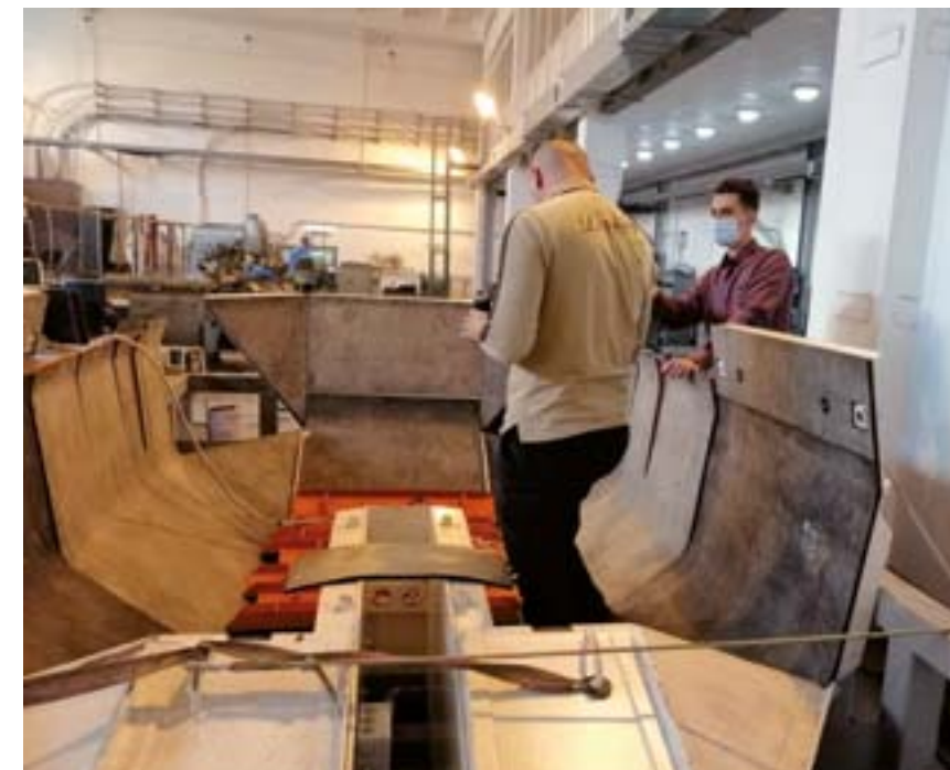
Аспиранты Института угля собирают лабораторную установку для определения радиуса чувствительности спектрально-акустического метода прогноза выбросоопасности
