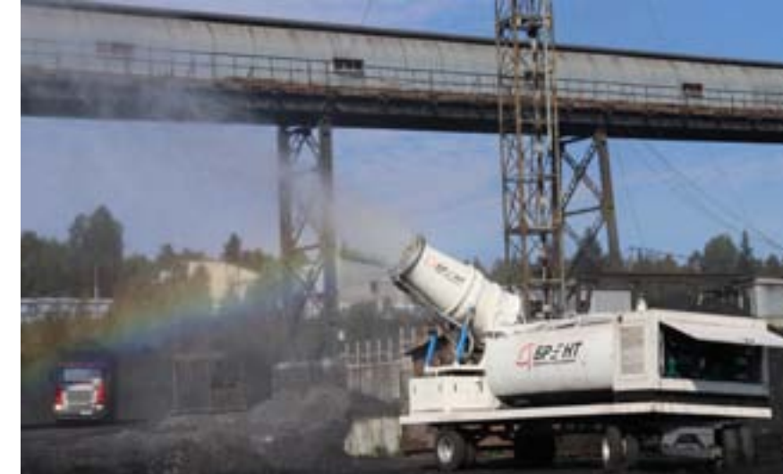
Мобильная установка пылеподавления на ОФ «Распадская»
