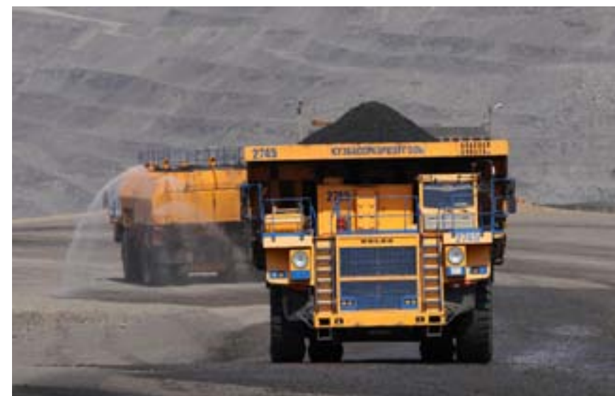
В Компании начали применять новые технологии пылеподавления. Технологические дороги разрезов обрабатываются специальным реагентом, удерживающим частицы пыли до восьми часов.
