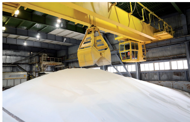
Главный компонент взрывчатки – это селитра. Сырье хранится на отдельном складе, откуда поступает в производственные цеха. Также селитру грузят в смесительно-зарядные машины.
