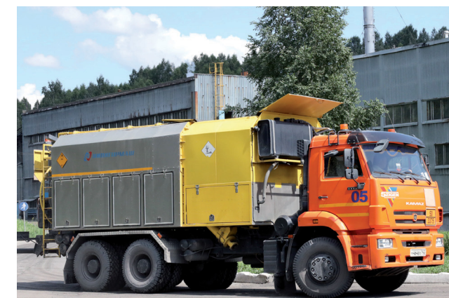
В автопарке завода – 25 смесительно-зарядных машин. Это техника представляет собой настоящий завод на колёсах. При смешении компонентов взрывчатого вещества компьютер рассчитывает вес с точностью до грамма.
